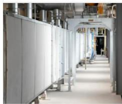
焼成炉 (素焼きトンネルキルン)
