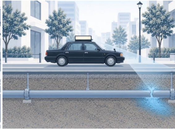
Fig. 02 走行中に路面下の水道管の漏水を検知するタクシー
