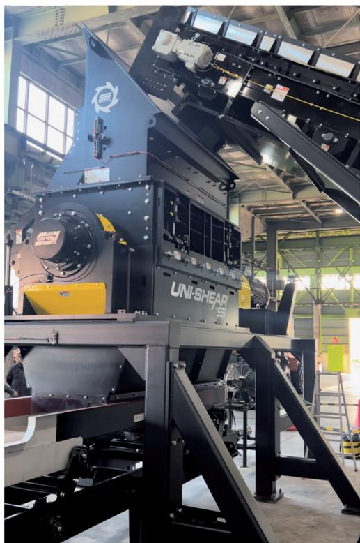
特殊な破碎機によりタイヤからワイヤーを取り除き破碎し、燃料化を実現
